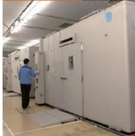
高温高湿状態での加速試験により、部品品質の信頼性を評価
