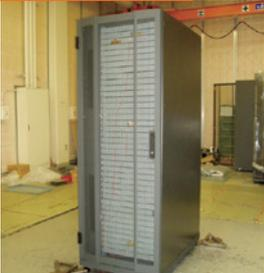
合成地震波試験による震度5の揺れでも壊れず、業務再開可能を検証
