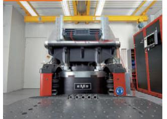
装置に振動を加えた後、正常に動作することを検証
