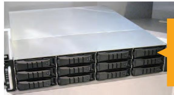
こちらは 2U サイズで12台のハードディスクを搭載できるモデル、J2012-1 (SSG-JBSA31S-2123T-5 5RP-B) です。デザインは、きわめて一般的なストレージエンクロージャです。
