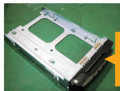
AIC のポイントは、ハードディスクトレイのネジが不要なところ。トレイ横の出っ張りの部分でハードディスクを固定します。
